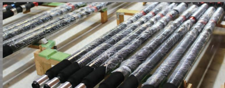
Boron ロッドに関して Restaffine が Full Length にこだわるのは、ロッドの縦方向に Boron 繊維の比類ない特質を求めるもので、ブランクスの手元に来るほどに構成素材のプライ数 [ 鉄芯に巻きつける回数 ] が多重構造になる「手元重心多重構造」の肉厚シャフトが、持ち重りの少ない粘りあるシャフトを生み出し「どうして Full Boron でこんなに軽いの?」と不思議がられる所以です。
